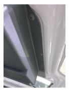
3. Die Verkleidung hochdrücken und insgesamt 4 Löcher im Abstand von 220 mm mit einem 5 mm Bohrer bohren. Immer erst ein Loch bohren und anschließend mit der beiligenden Niete vernieten, dann das Nächste.
