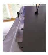
2. Die Verkleidung mit den übrig gebliebenen Clips an der Heckklappe befestigen.
