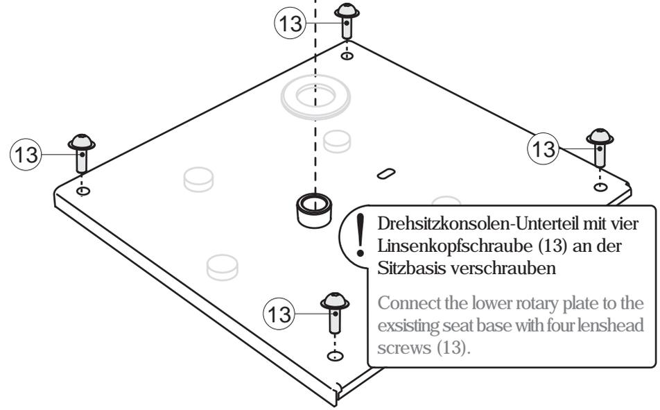
**!** Drehsitzkonsolen-Unterteil mit vier Linsenkopfschraube (13) an der Sitzbasis verschrauben
